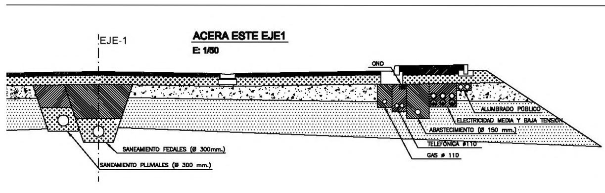
Vamos a centrarnos en la zanja de electricidad, como se observa en la figura se necesitarán seis tubos de diámetro 160 mm, los cuales están en un dado de hormigón en masa, encima hay una capa de zahorra (que es un material granular), después otra capa de hormigón y por último la baldosa de la acera), todas las medidas están indicadas.
