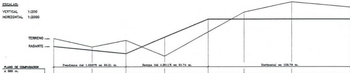
La **rasante** es una línea que define la inclinación o pendiente de una calle, camino, terreno u obra en general, respecto al plano horizontal. En la figura 2 se pueden observar dos líneas, son dos **perfiles longitudinales** (que es cortar el terreno por un plano e ir poniendo distancias en horizontal y cotas o alturas en vertical), que representan por un lado
