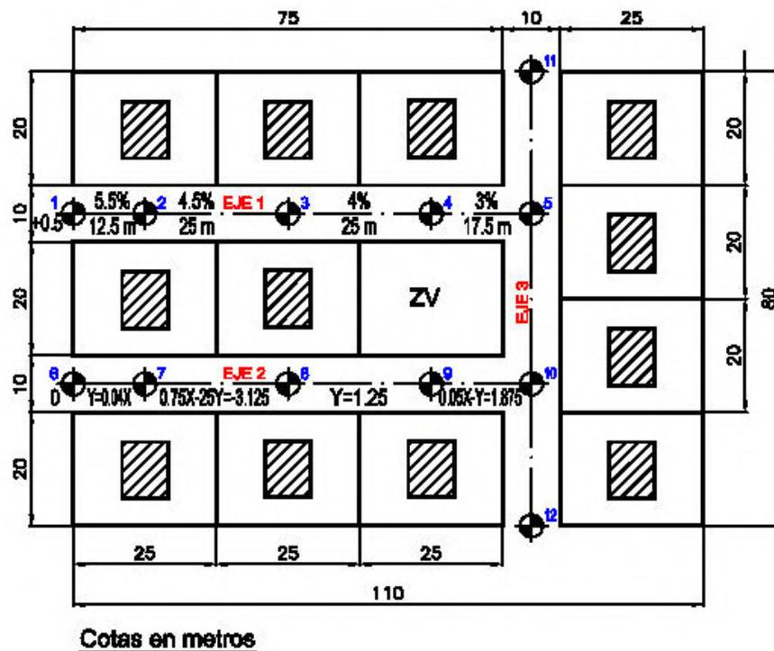
En la figura 4 tenemos definidos los ejes y las rasantes de nuestro proyecto de diferentes maneras; para el Eje-1, se ha definido la rasante de arranque, y las distancias en planta entre una rasante y otra y la pendiente correspondiente a ese tramo.
